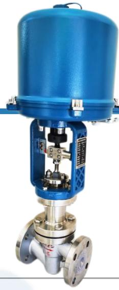
电动衬氟调节阀是由气动薄膜执行机构和防腐蚀直通低流阻单座阀组成。在与流体接触的阀体内壁和阀内组件均采用高温高压衬氟塑工艺，包覆一层聚全氟乙丙烯（F46），聚四氟乙烯（F4），可溶性聚四氟乙烯（PFA）等防腐蚀材料，完全能达到切断腐蚀性介质与阀体外壳的接触，具有密封性能好，动作灵敏、流体通道呈 S 流线型、压降损失小、阀容量大、流量特性精确，配用定位器，可实现对工艺管路流体介质的自动调节控制，广泛适用于酸、碱等强腐蚀性介质和有毒、易挥发、易渗透等气体、液体类介质的控制。
